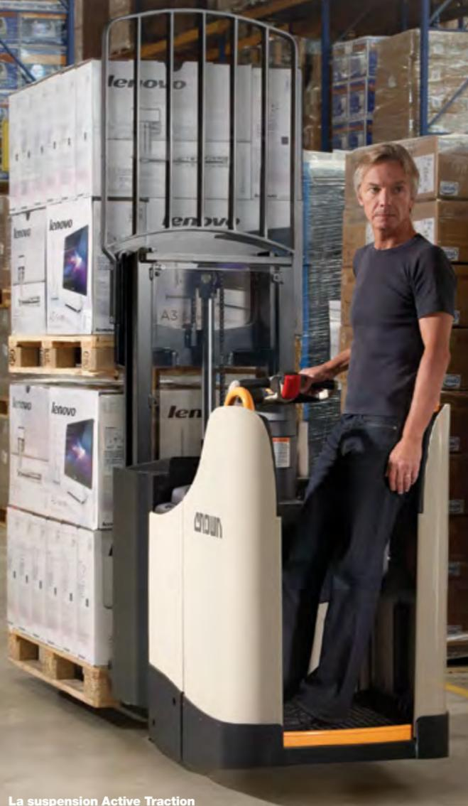
La suspension Active Traction avec direction électronique est équipée de composants hydrauliques et électroniques innovants qui modifient la pression au sol de la roue motrice en fonction de la distribution de la charge, de la vitesse, de l'accélération et du freinage.
