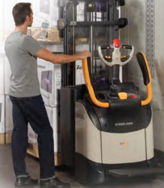
**Les protections latérales quick-exit escamotables (brevet en cours)** se relèvent pour permettre au cariste de gagner du temps en descendant du chariot sur le côté.
