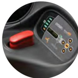
**Le module de contrôle complet Access 1 2 3®** comporte des réglages de performances programmables permettant d'adapter le chariot au niveau de compétences du cariste ou à la configuration des locaux.
