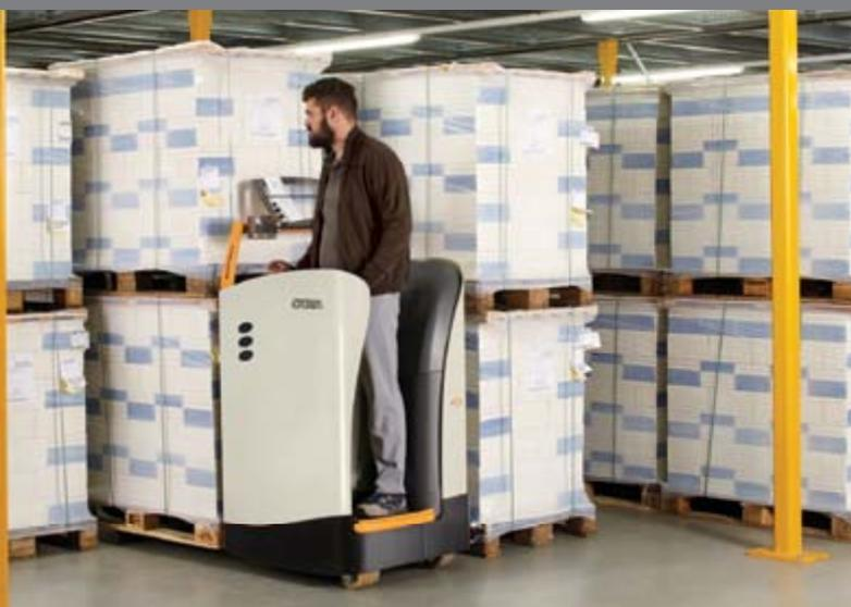
**Facile à manœuvrer dans les espaces restreints** – Direction réactive, châssis étroit et longueur totale plus courte permettent de simplifier le travail dans les zones de stockage exiguës et les allées étroites, assurant un avantage considérable pour l'entreposage.
