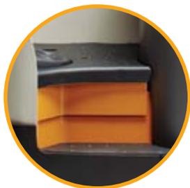
**Le plancher à hauteur réglable** de plus ou moins 60 mm permet aux caristes de choisir avec précision la position la plus confortable.
