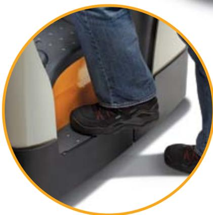
**La marche d'accès de faible hauteur** simplifie l'entrée et la sortie, réduisant la fatigue du cariste tout en fournissant un degré supérieur de sécurité.
