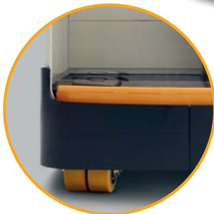
**Un plancher suspendu et des roues stabilisatrices montées sur ressorts** réduisent les chocs sur les plaques de liaison et les sols irréguliers, fournissant le meilleur confort de conduite dans cette catégorie.
