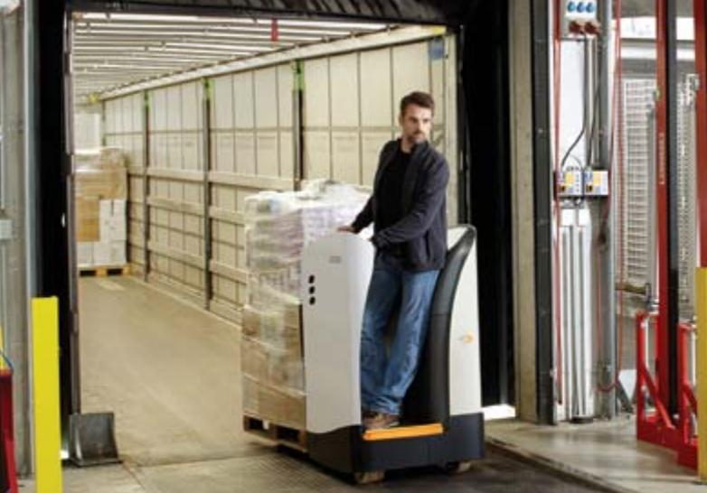
**Rapidité sur les quais de chargement** – Les caristes peuvent charger et décharger rapidement les camions avec le RT à conducteur debout extrêmement facile à manipuler équipé de commandes intuitives, d'un plancher suspendu et d'un châssis de seulement 780 mm de large.
