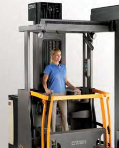
**Les tâches exigeant la position debout** sont accomplies avec une réelle efficacité grâce au siège escamotable et à des commandes réglables à la hauteur idéale.
