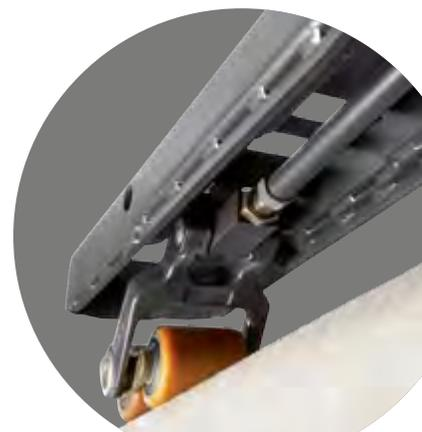
**Les fourches en acier hautement résistant sont d'une seule pièce.** Elles forment un profilé en C et sont renforcées aux endroits critiques. Le système de tirants de levage réglable élimine les risques de flambage, tandis que les axes du dispositif d'élévation sont placés en position haute sur les fourches pour une meilleure protection.
