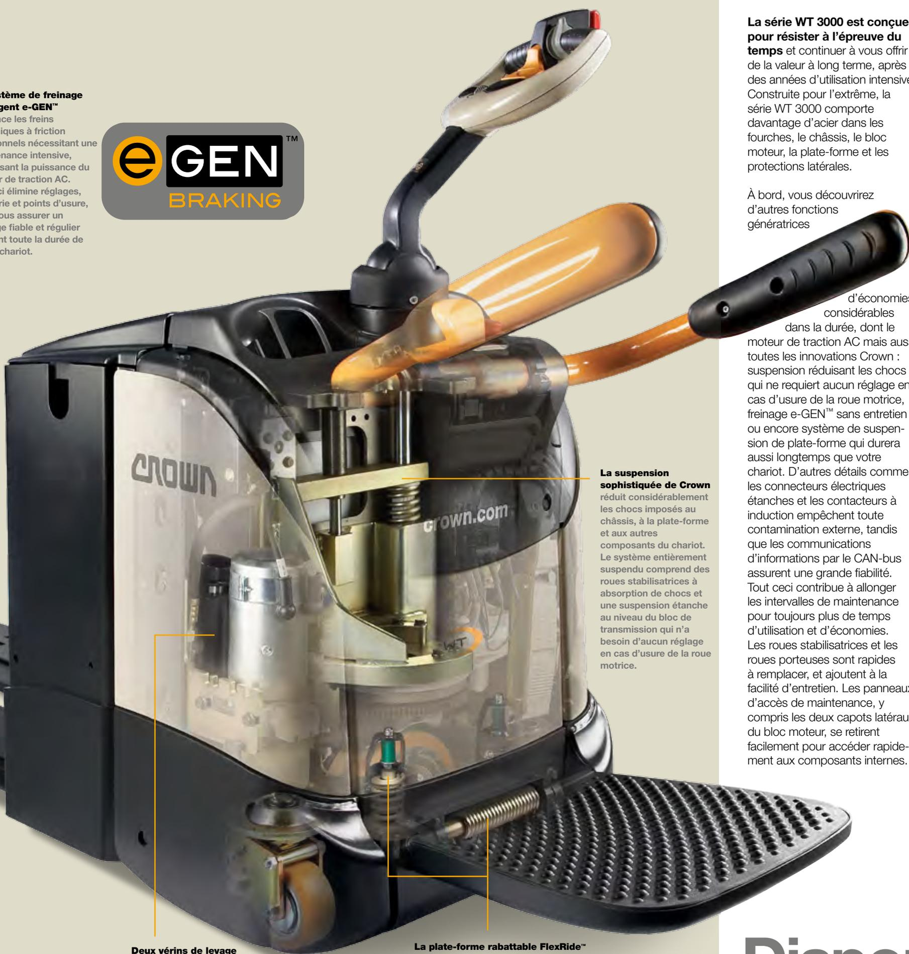
**La suspension sophistiquée de Crown** réduit considérablement les chocs imposés au châssis, à la plate-forme et aux autres composants du chariot. Le système entièrement suspendu comprend des roues stabilisatrices à absorption de chocs et une suspension étanche au niveau du bloc de transmission qui n'a besoin d'aucun réglage en cas d'usure de la roue motrice.
