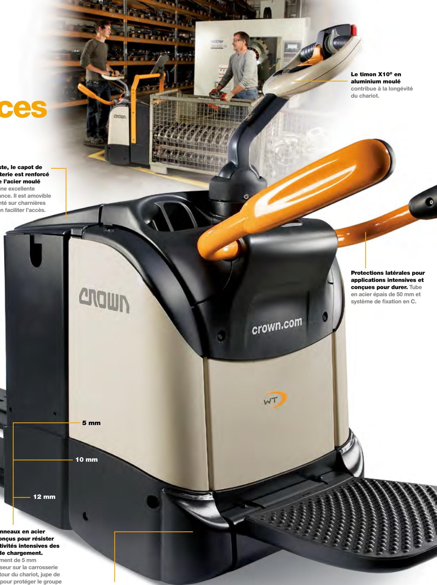
**Le système de freinage intelligent e-GEN™** remplace les freins mécaniques à friction traditionnels nécessitant une maintenance intensive, en utilisant la puissance du moteur de traction AC. Celui-ci élimine réglages, tringlerie et points d'usure, pour vous assurer un freinage fiable et régulier pendant toute la durée de vie du chariot.
